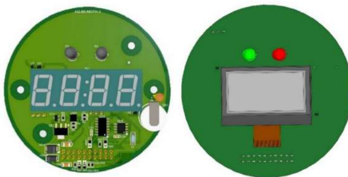
Рисунок 4. Общий вид блок процессора вид сверху для исполнения с LEDи OLEDиндикатором.
