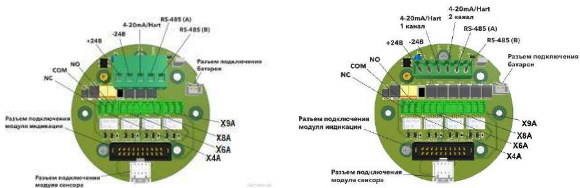
Рисунок 3. Общий вид модуля коммутации вид сверху для одно- и двухканального исполнения для трехпроводного подключения
