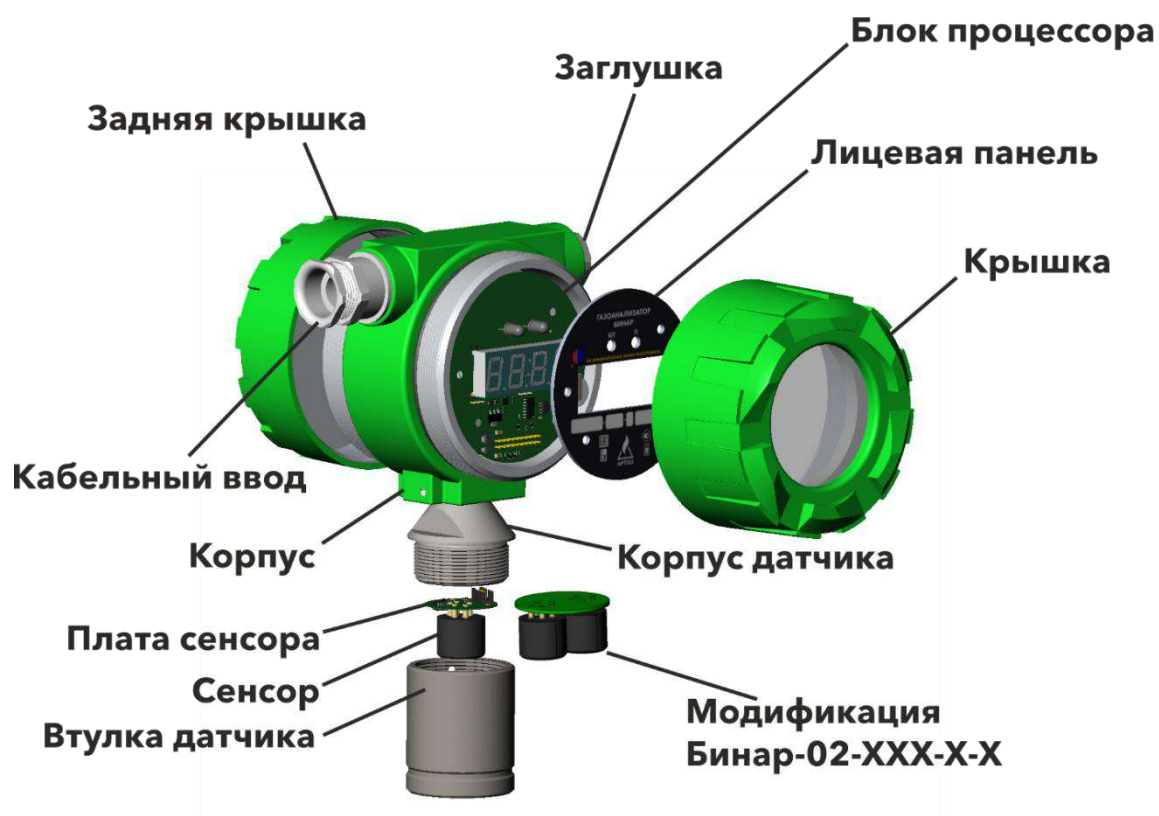
Рисунок 1.2 Газоанализатор Бинар-XX-XXX-Г-Х
